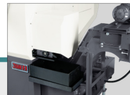
成品輸送裝置 工件加工完成後，可經由成品輸送機送出。免除成品表面撞傷。
